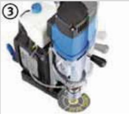
可移动式磁座，可以在设备已经吸到工件的状态下，机械调整钻头的位置。
