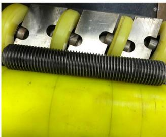
螺栓传送方式：双轴多轮对称反向传动，专利设计，确保传送的稳定性，增大螺栓的清洗面积。
