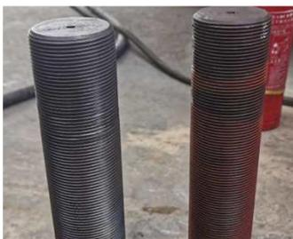
清洗效果对比，采用不锈钢刷清洗，除锈能力强，不伤本体，确保螺栓的完整性。
