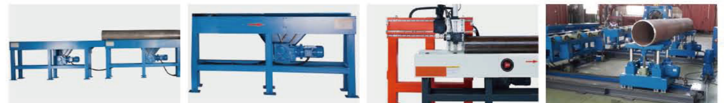
管道进料输送系统 Front pipe conveyer
