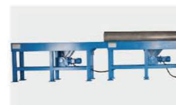
管道进料输送系统 Front pipe conveyer
