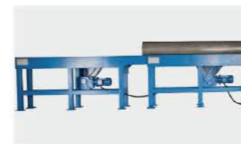
管道进料输送系统 Front pipe conveyer
